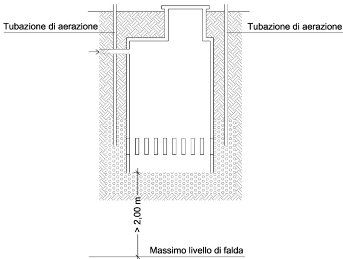
*Fig. 1 – Schema sezione longitudinale pozzo assorbente*
