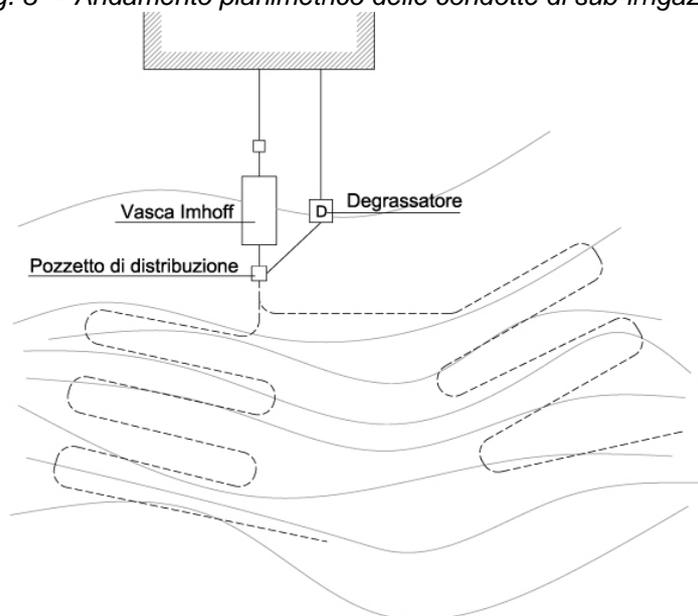
Fig. 4 – Disposizione delle condotte di sub-
